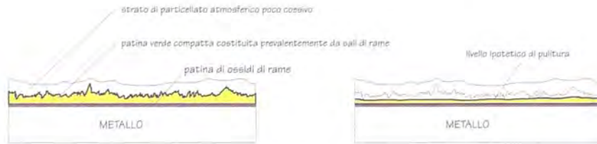
Tav. 2 - Schema del criterio adottato per la pulitura
