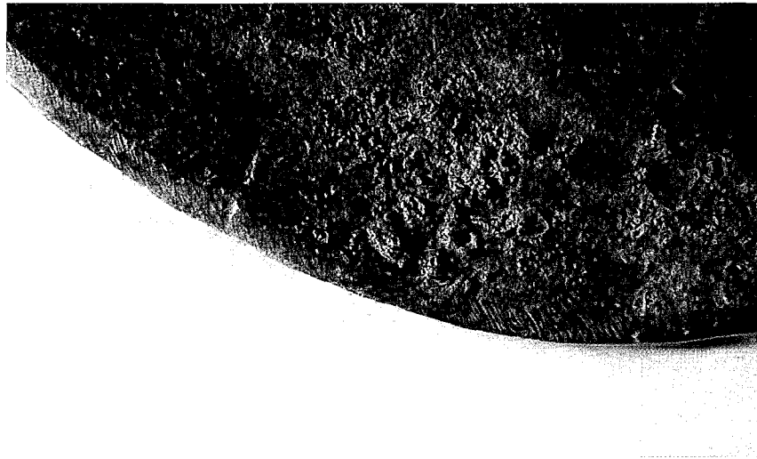
Fig. 15 - Tracce di lima poste sotto residui di terra di fusione vetrificata.
